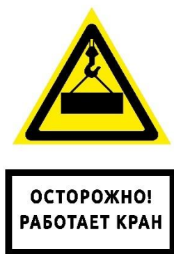
Рисунок 1. Предупреждающий знак «Осторожно! Работает кран». Места установки ограждения, при возможном падении предметов со строящегося здания.
