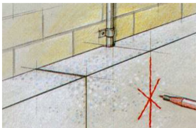
Рисунок 21 – Устройство разметки в местах прокладки инженерных сетей
