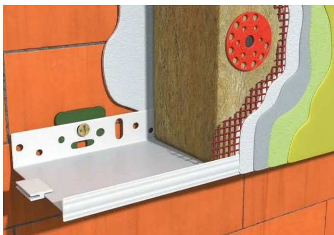
Рисунок 14 – Примыкание цокольной планки и теплоизоляционной плиты
